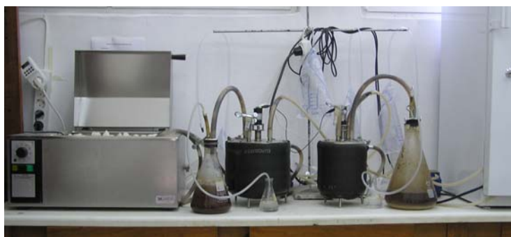
Εικόνα 5.2 Πειραματική διάταξη των αναερόβιων αντιδραστήρων συνεχούς λειτουργίας που χρησιμοποιήθηκαν στην ερευνητική εργασία.
